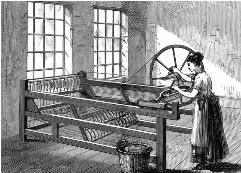
Máquina de hilar Spinning Jenny de Hargreaves (1764)
